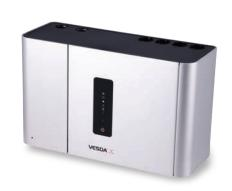
VEU探測器是VESDA-E系列抽氣式煙霧探測產品中的等級最高的探測器。具有超寬的靈敏度範圍,最高靈敏度是VESDA VLP產品的15倍;可設計更多的取樣孔,在高氣流的環境應用中至少可增加40%的保護面積。長距離的直線管道和可擴展的分支管網設置的完美結合,使其能應用於更高的天花板處,在增加80%覆蓋面積的同時,探測器安裝和維護也方便簡單。一系列革命性的新特性使該產品具有卓越探測性能,大大提高了靈活性、現場可程式設計性及連接特性,並可降低總成本。
